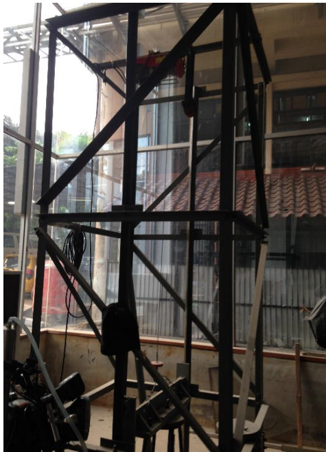
Gambar 6. Menara uji jatuh tinggi 3 m dengan tinggi beban jatuh 1,5 m
