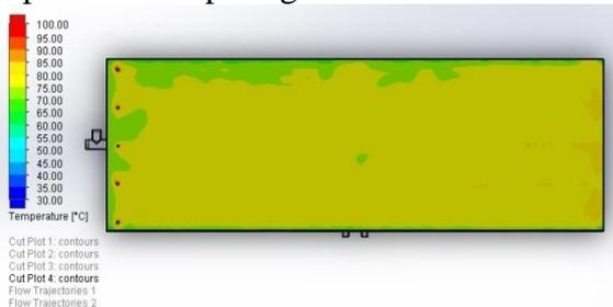
Gambar 10. Hasil Simulasi CFD Pada Rak Tingkat Keempat
