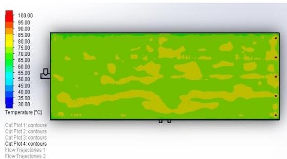
Gambar 9. Hasil Simulasi CFD Pada Rak Tingkat Ketiga
