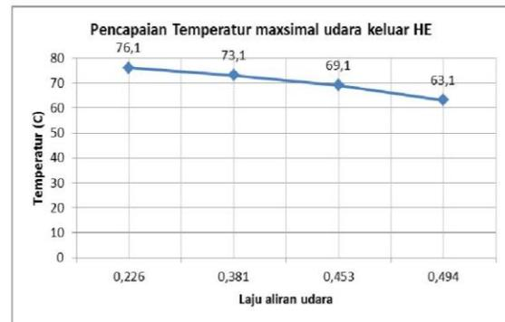
Gambar 6. Grafik temperatur maksimal udara keluar *heat exchanger*
