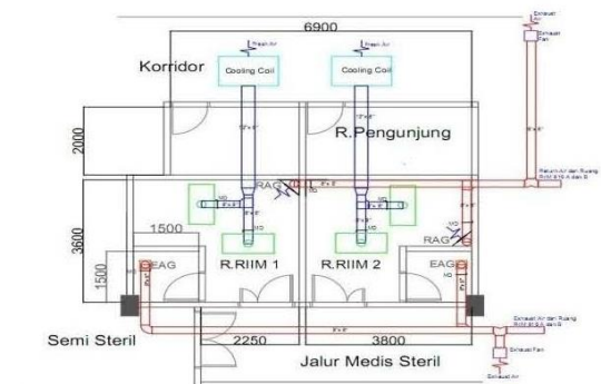
Gambar 5. Denah instalasi tata udara RIIM disain existing (Skala 1:100)
