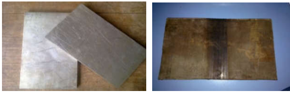
Gambar 1. Bahan plat aluminium (kiri) dan plat aluminium dengan sambungan FSW (kanan).
