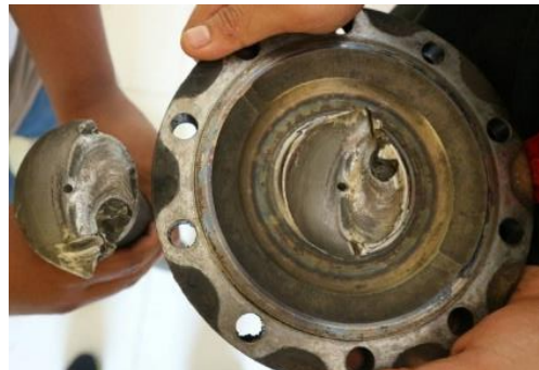
Gambar 6. Patahan Yang Terjadi Pada Poros Roda Belakang
