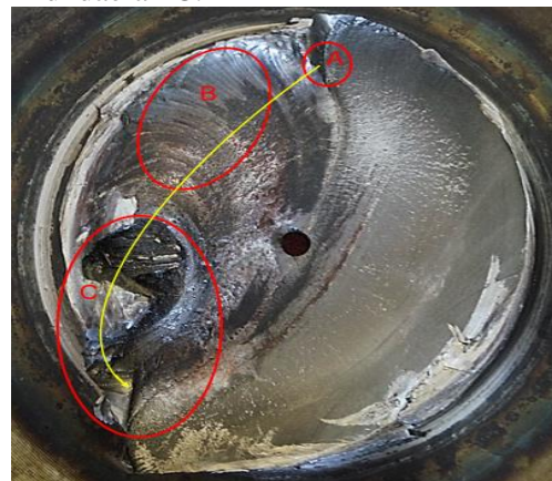
Gambar 9. Arah Patahan Poros Roda Belakang
