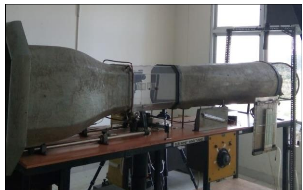
Gambar 3. Instalasi pengujian pada wind tunnel sub-sonic
