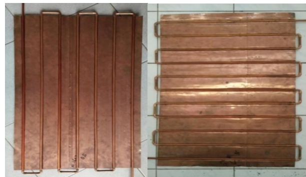
Gambar 4. Rangkaian pipa dan pelat kolektor surya. (a). Jarak antara pipa ( W ) = 80 mm, short elbow 90°, vertikal. (b). II. W = 80 mm, short elbow 90°, horizontal.
