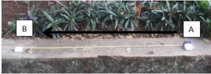
Gambar 3. Pengukuran kecepatan aliran air
