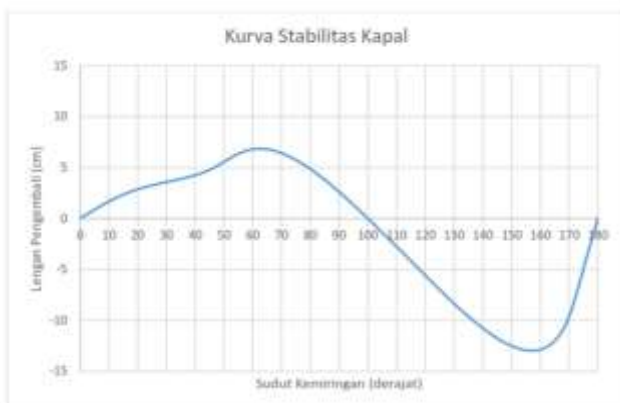
Gambar 4. Grafik stabilitas kapal tenaga surya
