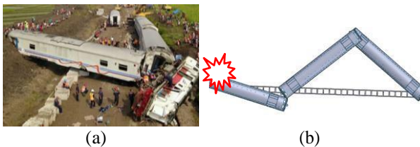
Gambar 1. (a) Tumbukan KA Sancaka [3] dan (b) ilustrasi modus kegagalan lateral buckling
