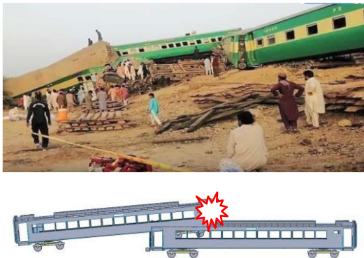
Gambar 2. (a) Tumbukan Akbar Express Pakistan [4] dan (b) Ilustrasi modus kegagalan tumpang tindih
