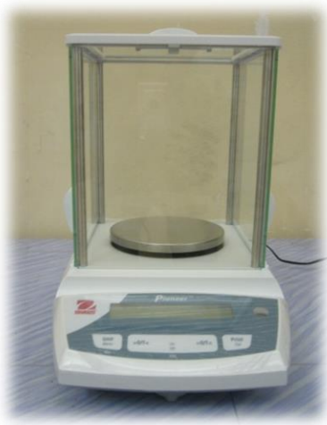
Gambar 4. Timbangan Digital dengan ketelitian 0,001 gram
