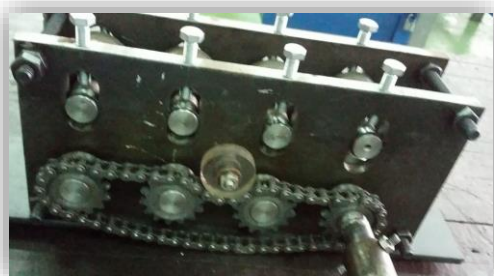
Gambar 16. Bagian penggerak mesin rolling
