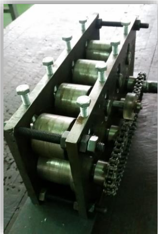
Gambar 15. Mesin rolling dengan 4 roller
