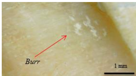
Gambar 10. Permukaan dinding lubang tulang sapi tanpa penggunaan coolant
