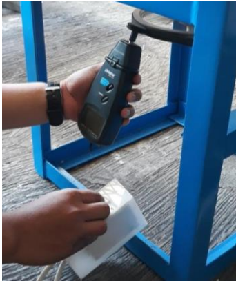
Gambar 2. Mengatur Kecepatan Putaran Pisau Pemotong Menggunakan Potensio Arus AC
