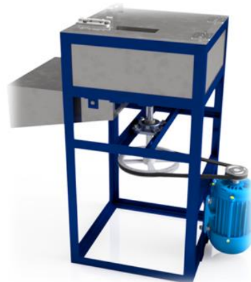
Gambar 5. Desain Mesin Pemotong Pisang
