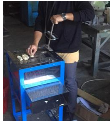
Gambar 10. Pengujian Kapasitas Mesin Pemotong Pisang
