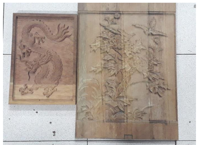
Gambar 13. Hasil ukiran dengan menggunakan mesin router
