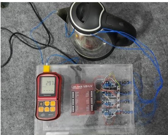
Gambar 2. Rangkaian data akuisisi Termokopel tipe K + modul Amplifier AD620
