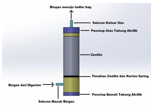
Gambar 1. Skema alat pemurni biogas.
