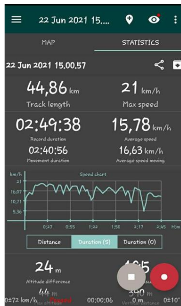
GAMBAR 11. Data uji coba awal sepeda listrik
