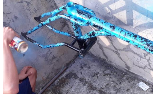
GAMBAR 8. Pewarnaan, pembuatan corak marbel dan varnish
