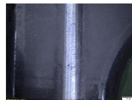
Gambar 7 Area yang terkena Bending dengan magnification 0,67x
