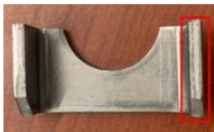
Gambar 3 Bagian yang terkena proses Cutting
