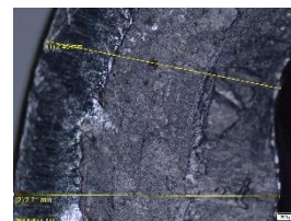
Gambar 8 Hasil Bending dengan magnification 4,5x
