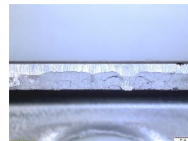
Gambar 9 Hasil Piercing dengan magnification 0,67x
