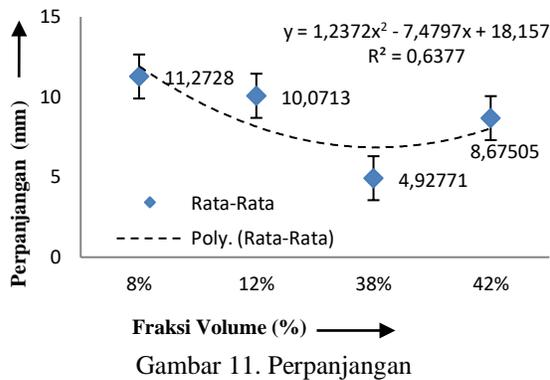
Penambahan perpanjangan uji bending cenderung mengalami peningkatan dengan rata-rata yang paling tinggi terdapat pada fraksi volume *Filler* 38% yaitu 4.92771 mm. Variasi perepanjangan karena terjadi penyebaran antara *Matriks* dan *Filler* pada saat pencetakan komposit tidak merata sehingga daya ikat *Filler* dan *Matriks* kurang baik. Bila dilihat dari keseluruhan fraksi volume, terlihat jelas perbedaan perpanjangan pada fraksi volume yang mengalami perubahan yang signifikan.
