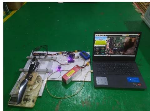
Gambar 3. Setup pengujian static thrust.
