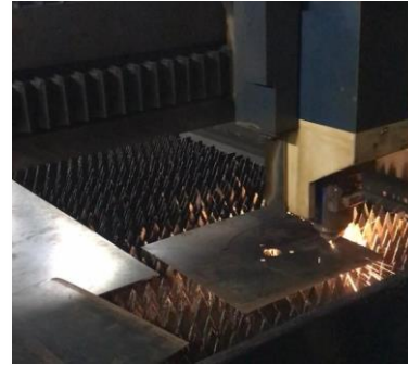
Gambar 5. Pemotongan pelat menggunakan laser cutting
