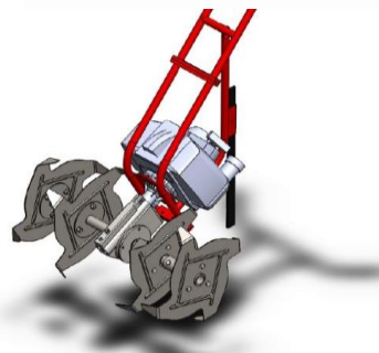
Gambar 3. Blade yang terpasang pada tractorpack
