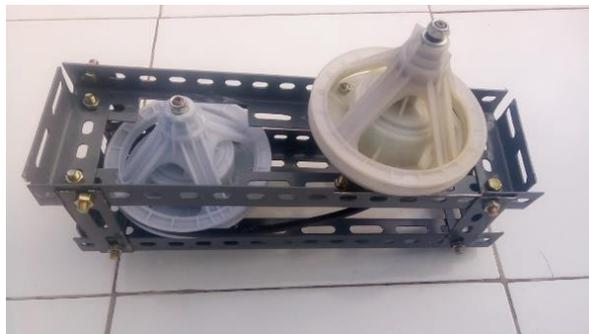
Gambar 4. Sistem transmisi *tracker*
