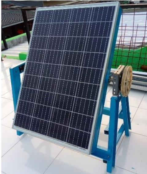
Gambar 3. Rangka dan dudukan *tracker* panel surya
