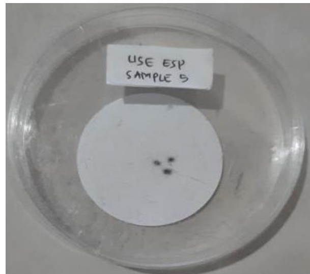
Gambar 4. Emisi particulate menggunakan Filter (ESP)
