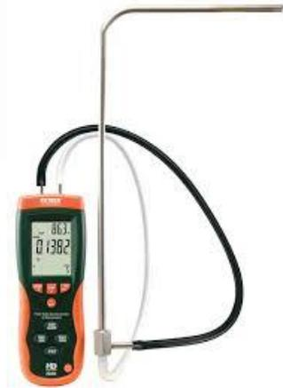
Gambar 5. Pitot tube yang dipergunakan
