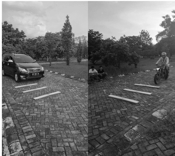
Gambar 10 Pengujian Pengambilan Data dimana Rumble Strip di Lewati oleh mobil dan Sepeda Motor
