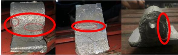
Gambar 10. Cacat pada Benda kerja hasil penuangan logam cair pada *bottom gating system* dengan kecepatan 1,6 detik
