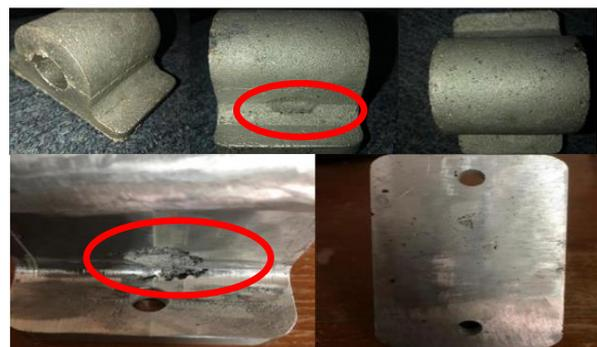
Gambar 8. Cacat pada benda kerja hasil penuangan logam cair pada top gating system dengan kecepatan 1,6 detik
