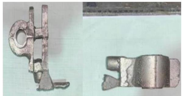
Gambar 9. Benda kerja hasil penuangan logam cair pada *bottom gating system* dengan kecepatan 1,6 detik
