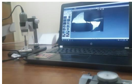
Gambar 2 Pengukuran keausan pahat
