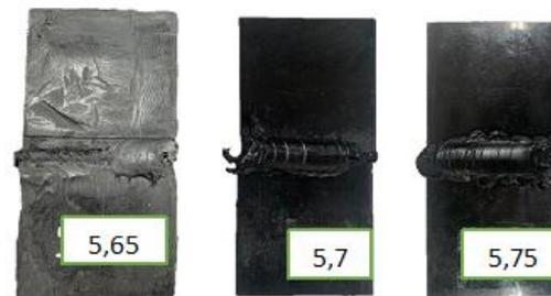
Gambar 7. Hasil pengelasan FSW
