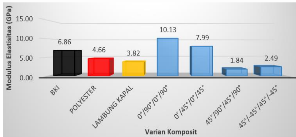
Gambar 8. Modulus elastisitas bending material komposit
