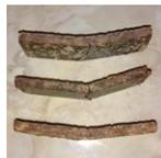
Gambar 9. Spesimen hasil pengujian MOR dan MOE
