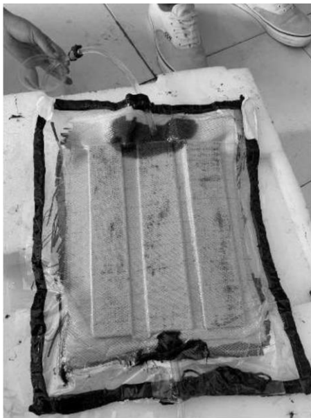
Gambar 5. Proses pembuatan spesimen menggunakan metode vacuum infusion .
