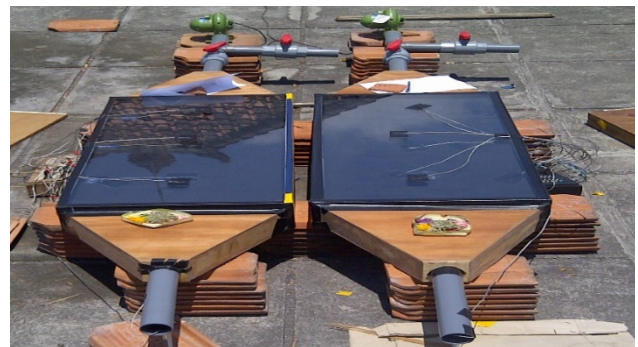
Gambar 6. Foto pengujian kolektor surya pelat datar dengan pelat penghalang staggered pada saluran fluida
