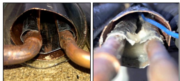
Gambar 4. (a) ETC standar dan (b) ETC dengan penambahan PCM
