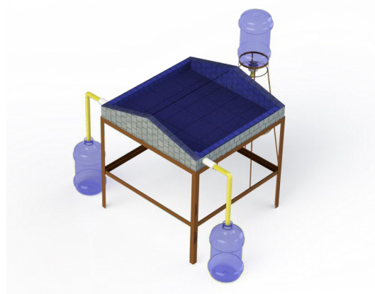
Gambar 2. Proses destilasi Air laut menjadi air bersih
