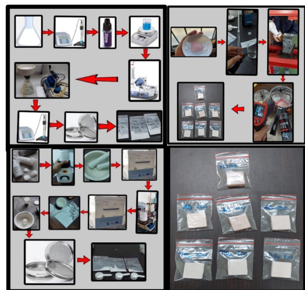
Gambar 1.a. Skema Proses Silanisasi b. Skema Proses kalsinasi Cangkang Kerang Darah c. proses pembuatan gigi tiruan berbasis akrilik d. sample gigi tiruan untuk pengujian
